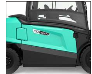
Puerta lateral del compartimento de la batería
